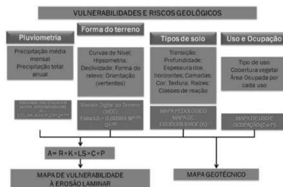
Figura 1. Vulnerabilidade e riscos relacionados à erosão laminar provocada pela chuva. Fonte: Autores.
