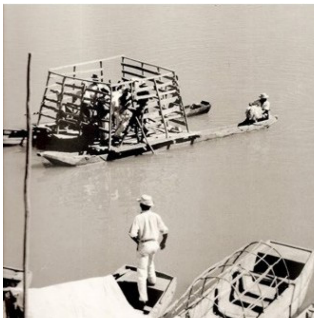
FIGURA 4 – Bom Jesus da Lapa, balsa de travessia montada com a técnica do Ajoujo. Onde temos duas canoas monóxilas atadas por uma plataforma de curral. Detalhe de foto de Marcel Gautherot, 1946.
