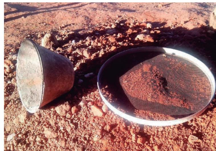
Figura 4: Balde utilizado como base de medida para construção dos tijolos (Wataru, 2013).
