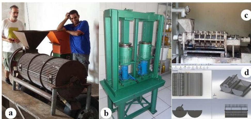
**Figura 2.** Maquinário de beneficiamento do licuri: (a) despeldadeira (Povoado Caixão, Cansanção, BA); (b) prensa manual para extração de óleo (Coopes, Capim Grosso, BA); (c) máquina de extração de óleo (EFASE, Monte Santo, BA); (d) projeto de despeldadeira.
